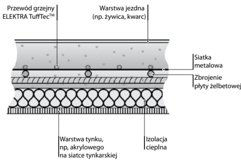
Przekrój wiszącej rampy rozładowanej
