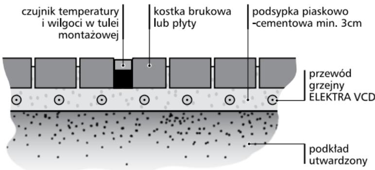
Przekrój chodnika lub podjazdu wykonanego z płyt lub kostki brukowej
