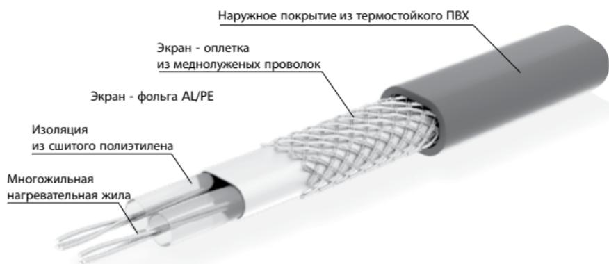
Конструкция нагревательного кабеля ELEKTRA VCD
