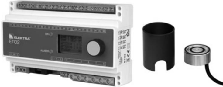
Regulator ELEKTRA ETOG2 – obciążalność 3x16A. Stosowany w dużych instalacjach. Standardowo wyposażony w jeden czujnik temperatury i wilgotności oraz tuleję montażową. Do sterownika można podłączyć drugi, dodatkowy czujnik temperatury i wilgotności, co pozwoli na ochronę dwóch powierzchni zewnętrznych.
