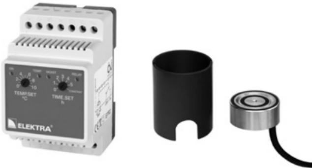
Терморегулятор ELEKTRA ETR2G рассчитан на 16А, поэтому общая мощность установленного нагревательного кабеля не должна превышать 3600 Вт. Комплектуется одним датчиком температуры и влажности. Датчик поставляется с цилиндрическим основанием.
