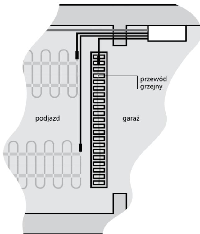
Ogrzewanie odwodnienia liniowego
