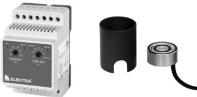
Regulator ELEKTRA ETR2G – obciążalność 16A – łączna moc zainstalowanych przewodów grzejnych nie powinna przekraczać 3600W. Standardowo wyposażony w jeden czujnik temperatury i wilgoci z tuleją montażową.
