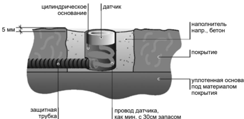
**Пример монтажа датчика температуры и влажности
