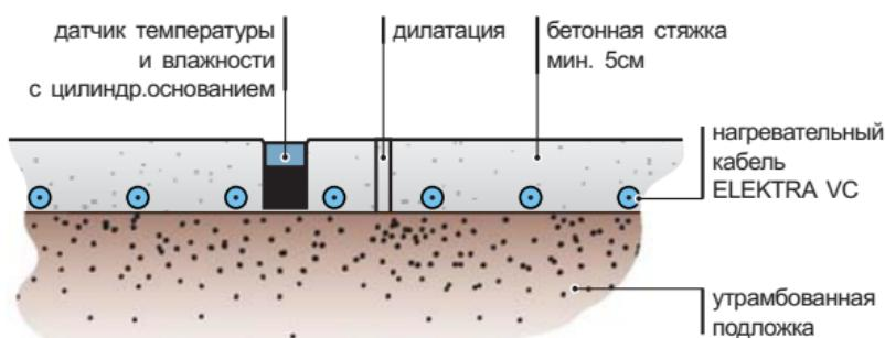
Конструкция подъездных путей с бетонным покрытием в разрезе
