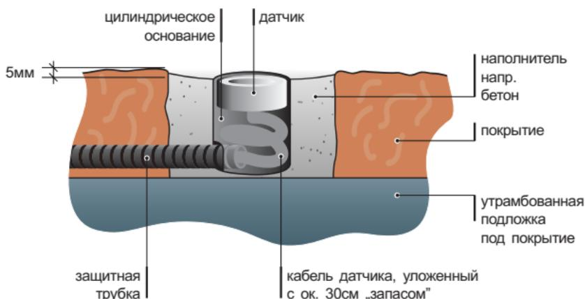
**Пример монтажа датчика температуры
