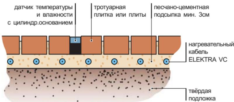
**Конструкция подъездных путей с тротуарной плиткой или брусчаткой в разрезе**
