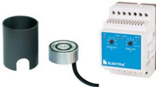
Терморегулятор ELEKTRA ETR2G рассчитан на 16А, поэтому общая нагрузка не должна превышать 3600Вт. Стандартно оснащён одним датчиком температуры и влажности с цилиндрическим основанием.
