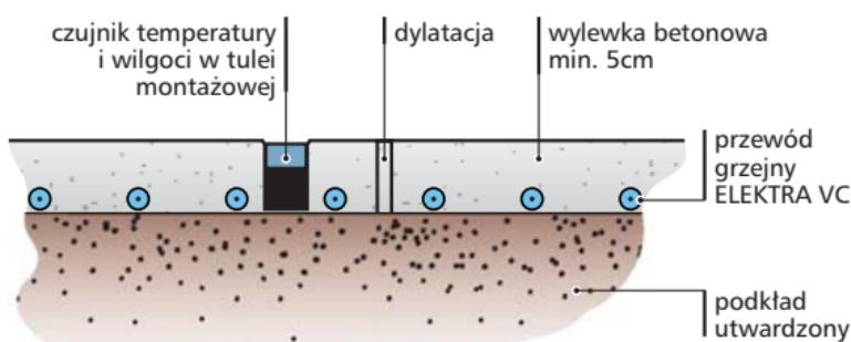
**Przekrój chodnika lub podjazdu wykonanego z wylewką betonową**
