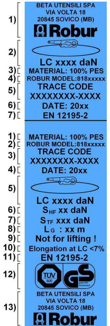
Il colore blu dell'etichetta identifica in maniera immediata il tipo di materiale di cui è composto il nastro, PES (poliestere) 100%.
