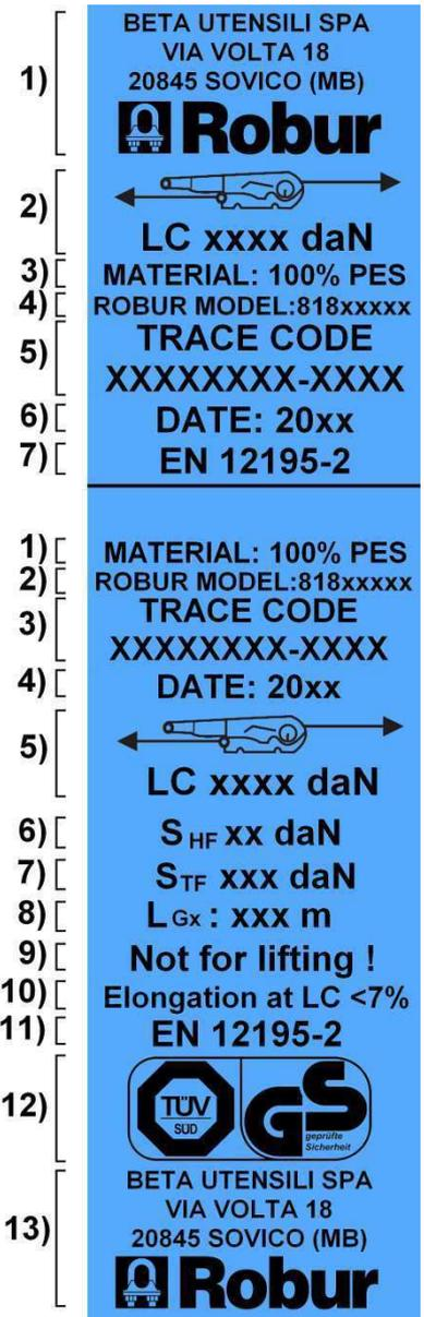
Il colore blu dell'etichetta identifica in maniera immediata il tipo di materiale di cui è composto il nastro, PES (poliestere) 100%.
